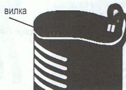
4. Включить зарядное устройство в бытовую электросеть (-220 В, 50 Гц) на 8 часов.
