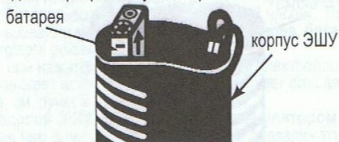
4. Установить батарею в батарейный отсек клеммами вверх.
